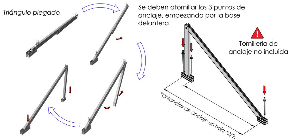
Apriete de las uniones y anclaje al suelo mediante tornillo de hasta M10.
